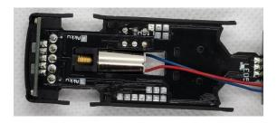
Kleben Sie mit etwas Sekundenkleber die Akkuhalterungen auf die PCB-Main wie in den Bilder dargestellt.
